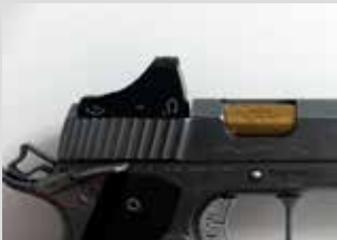
Patrone ist abgefeuert, Schlitten vorn, Lauf oben
