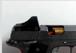
Schlitten ist auf dem Weg nach hinten, Lauf deutlich abgekippt, Patrone steht unmittelbar vor dem Auswerfen bereits schräg
