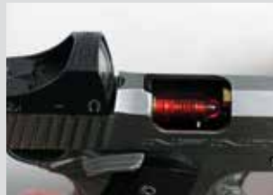
Schlitten vollständig hinten, neue Patrone wird hochgedrückt und zugeführt
